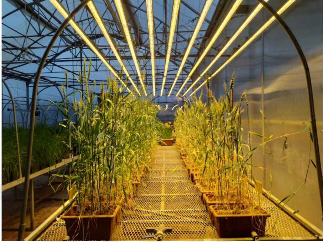
Resim 3.5 Hızlı ıslah için kullanılan LED ışık sistemi. Tüm deney düzeneği sabit metal tezgâh üzerinde yer almakta olup, sistem otomasyonla gece-gündüz döngüsüne göre yönetilmektedir
