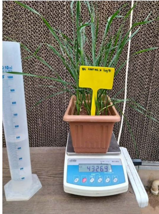
Resim 3.1 Her genotipe ait saksılarda sulama ölçümlerinin sağlıklı yapılabilmesi amacıyla 4 kg tarla toprağı ile doldurulan saksıların ağırlık kontrolü gerçekleştirilmiştir. Topraklar, homojen bir yapı elde edebilmek için 1 cm’den küçük parçalara ayrılarak elenmiş ve eşit dağılım sağlanmıştır.
