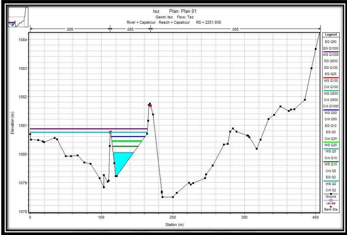
Şekil 5.28. 2251.93 nolu enkesit için taşkın kotları (Çapakçur Çayı)
