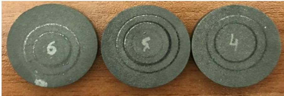
Şekil 3.4: D-Gun kaplama yöntemiyle üretilen MCrAlY metalik bağ kaplama.
