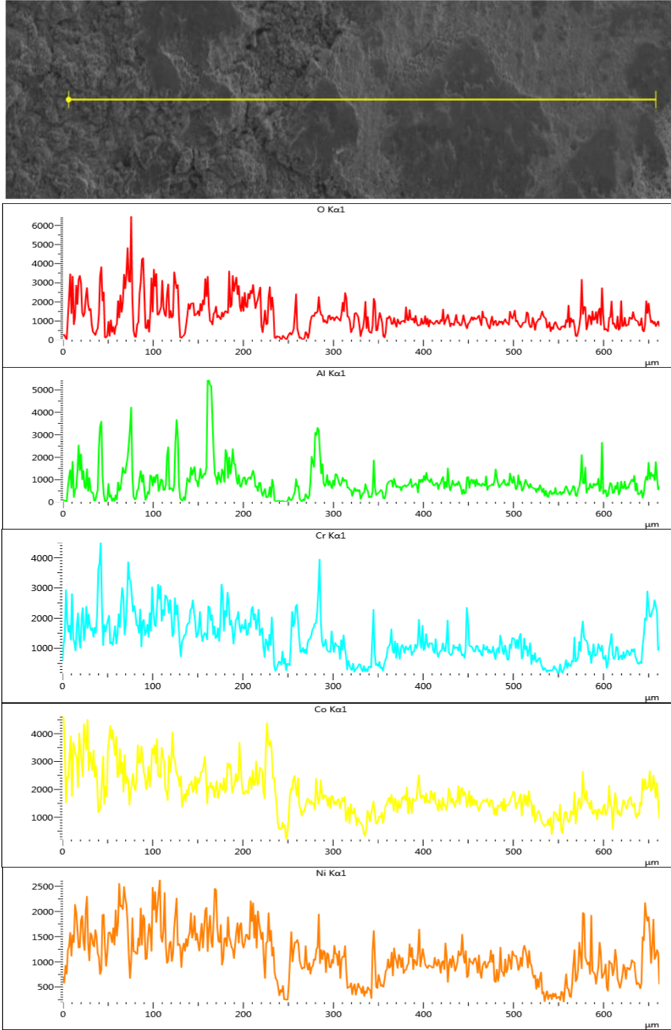
Şekil 4.29: SAPS kaplama yöntemiyle üretilen, 500 °C sıcaklıkta ve 2N yük altında aşınma testine tabi tutulan kaplamanın line-EDS analizleri.
