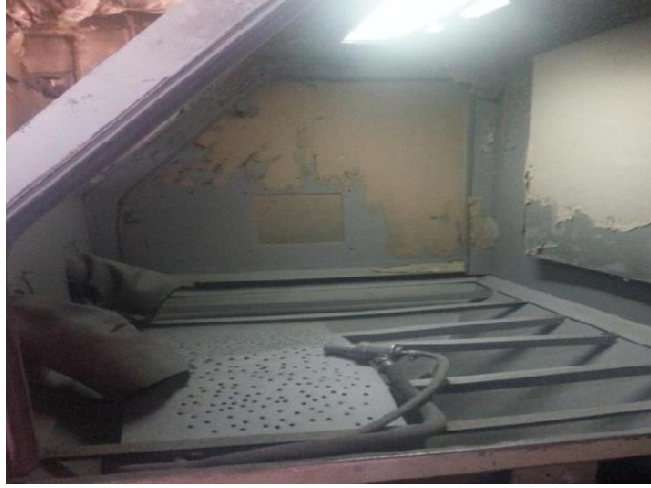
Şekil 2.2: Kumlama işleminin gerçekleştirildiği ekipmanın gösterimi (Meşekıran, 2015).
