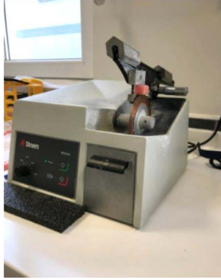
Resim 14. Akrilik bloğa gömülü dişlerden minitom cihazı ile kesit elde edilmesi
