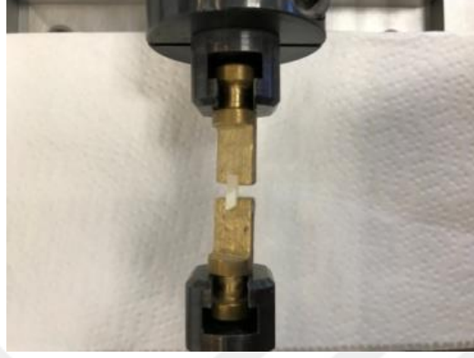
Resim 16. Mikrotensile cihazına siyanoakrilat ile yapıştırılan kompozit rezin-dentin çubuk
