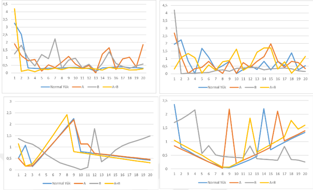
Şekil 3.48. Kaynakların 8 Numaralı Yük Yapı Numarasına Göre Düşük Güvenlik Düzeyi için Z-Skorlarının Grafikleri (Sol Üst-CPU, Sağ Üst RAM, Sol Alt-NETİ, Sağ Alt-NETO)
