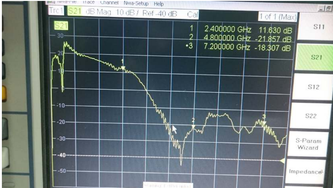
Şekil 4.32 Power amplifier'a ait S 21 parametrelerinin ölçüm değerleri
