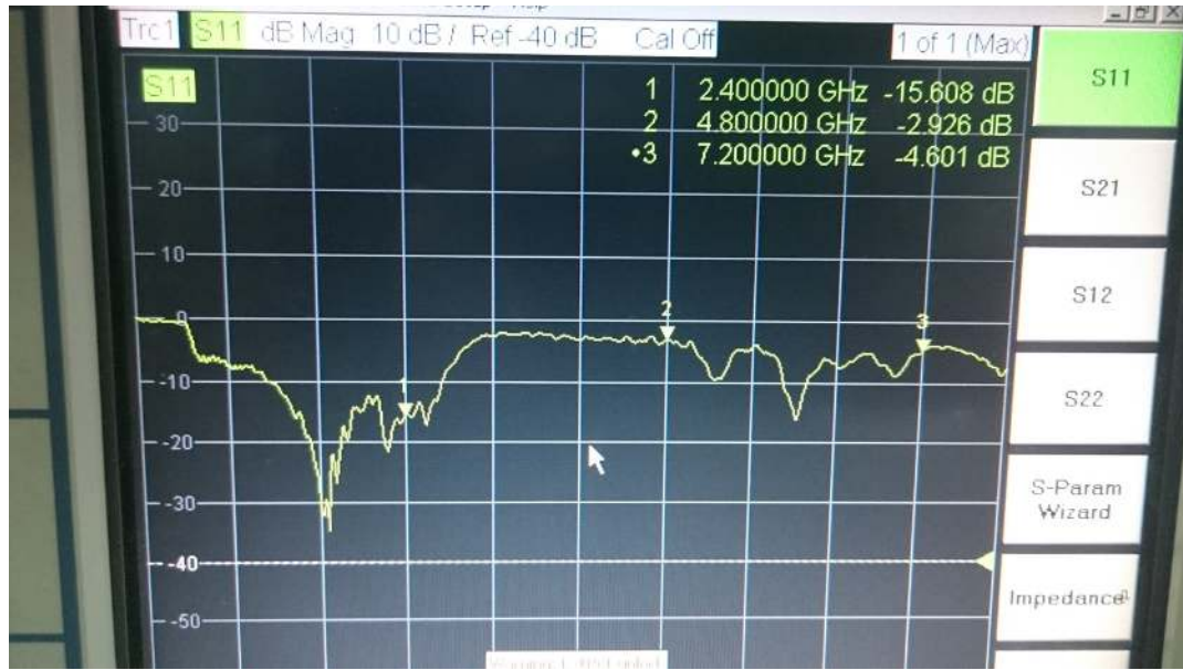
Şekil 4.30 Power amplifier'a ait S_{11} parametrelerinin ölçüm değerleri
