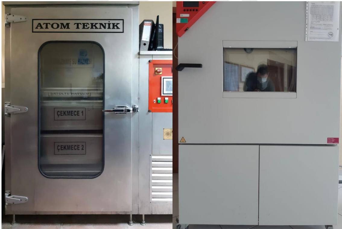
Şekil 2.26. İklimlendirme ve nem dolapları
