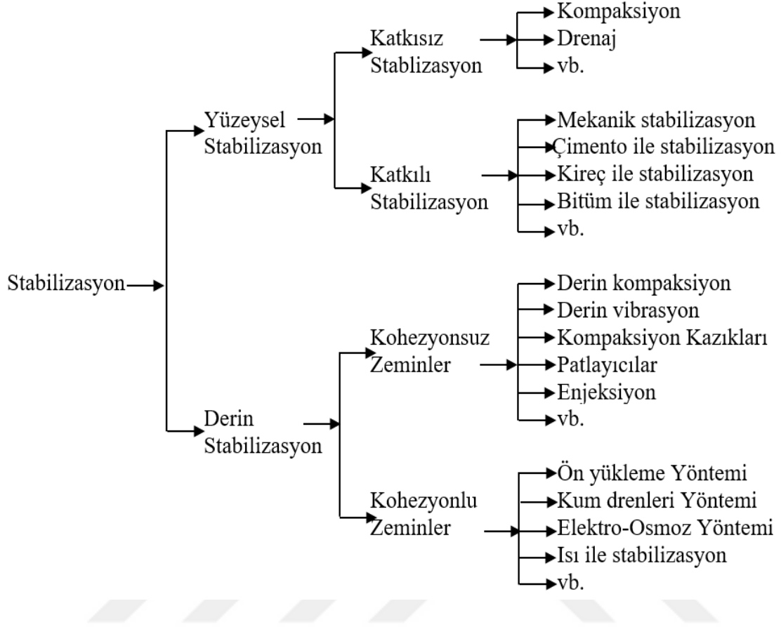
Şekil 1.1. Stabilizasyon teknikleri (Uzuner, 2019).
