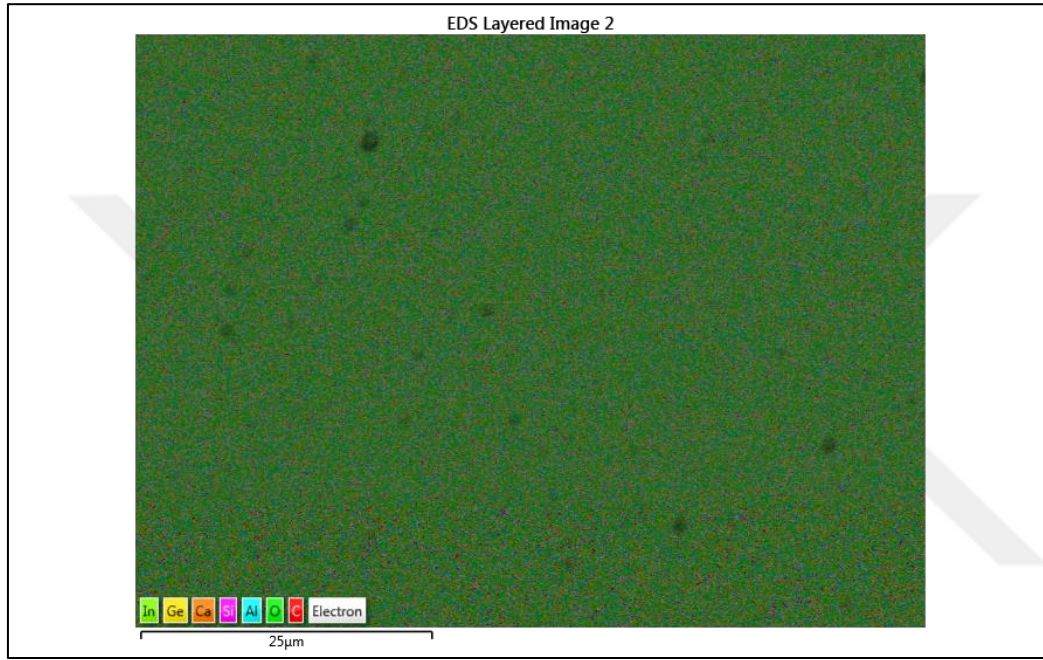
Şekil 5.27. \text{Al}_2\text{O}_3/\text{Ge}/\text{ITO}/\text{SKC} numunesi içindeki temel dağılımı gösteren X-ışını haritası
