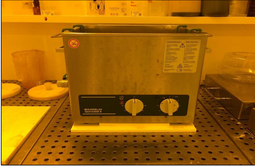
Resim 5.1. Wet Bench (Bench Top Hot Plate) ultrasonik banyosu
