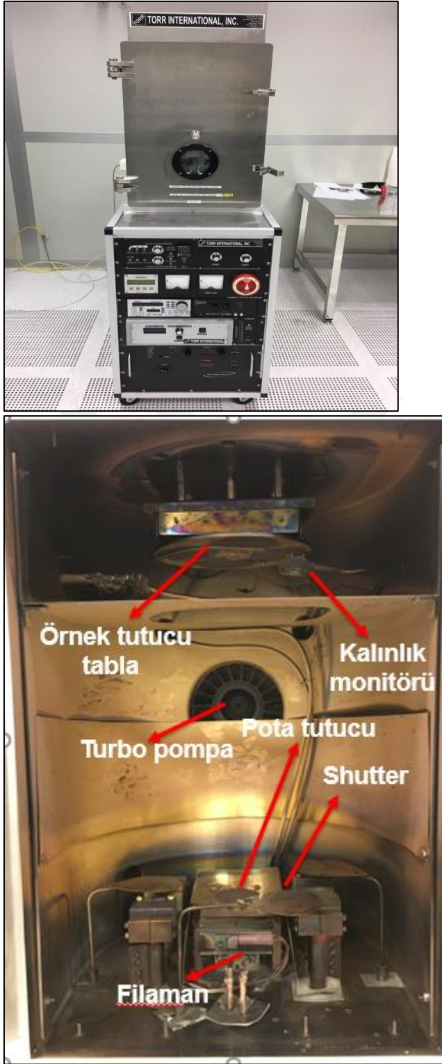
Resim 5.2. Torr e-demeti buharlaştırma sistemi görseli
