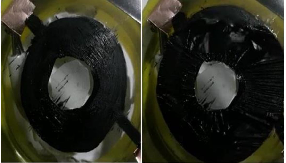
Şekil 4. 5. DEA gerilim altında deformasyon oluşumu.
