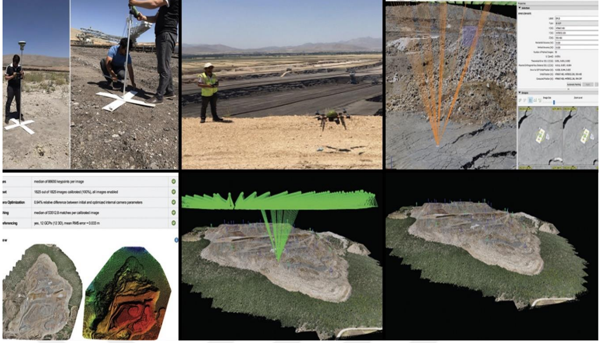
Şekil 4.17. Hava fotogrametrisi kullanarak hali hazır harita üretim aşamaları (Gül, 2019: 102)
