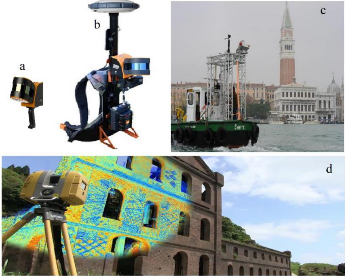
Şekil 4.21. Yersel lazer tarayıcı modelleri (a: El tipi lazer tarayıcı, b: Giyilebilir lazer tarayıcı, c: Mobil lazer tarayıcı ve d: Sabit lazer tarayıcı) (Balcı, 2022: 29)
