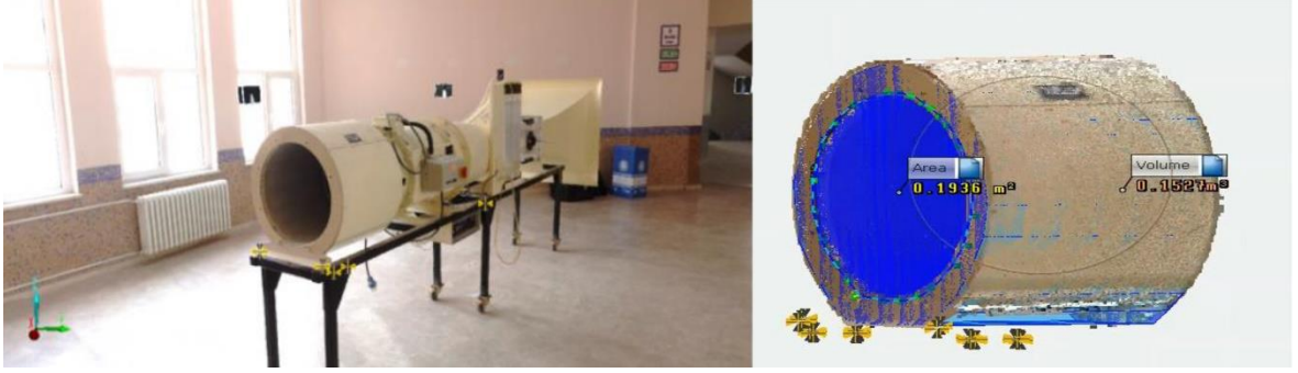
Şekil 4. 23. Lazer tarama yöntemi ile havalandırma cihazının ölçümü (Karasaka ve Beg, 2021: 56-57)
