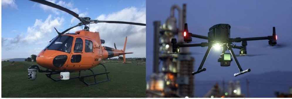
Şekil 4.20. Havasal lazer taramada kullanılan helikopter (Anonim 8) ve İnsansız hava aracı (Anonymous 2) örneği
