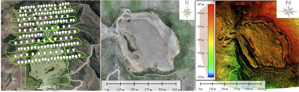
Şekil 4.12. Fotogrametrik yöntemle maden sahasının haritalandırılması (Kabadayı, 2022: 21)
