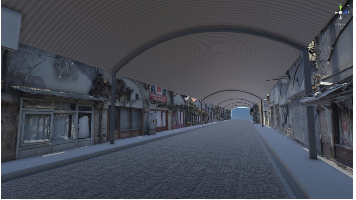
Şekil 5.15. Çalışma alanının tonoz örtü ile kapatılması
