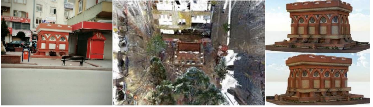
Şekil 4.25. Yersel lazer taramanın akıllı kent uygulamalarında kullanımı (Fidan ve Fidan, 2021: 51-54)
