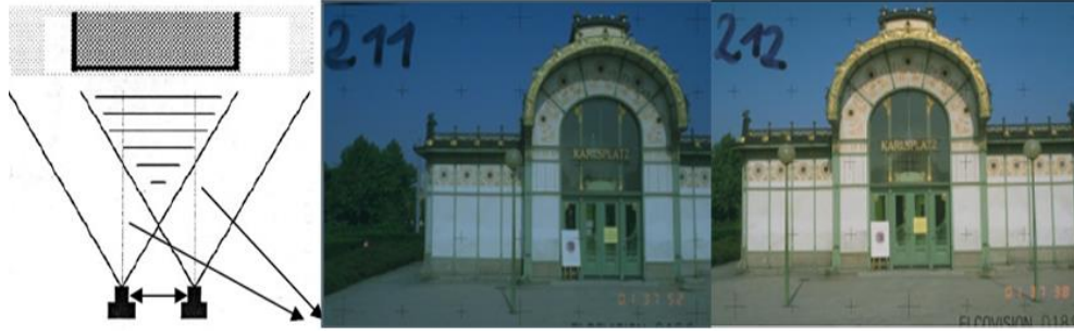
Şekil 4.3. Stereo görüntü yönteminde makinelerin konumlandırılması ve Otto Wagner Pavilyonu örneği (Hanke ve Grussenmeyer, 2002: 4)
