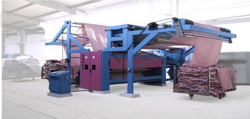
Şekil 3. 3. Osthoff-Senge gazeleme makinesi ( https://www.iteks.com/PC/15/Yakma-Hatlari.html )
