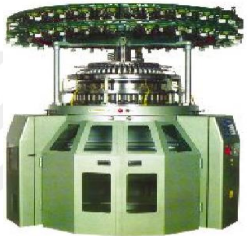
Şekil 3. 2. Monarch VX- SD3BY model tek plaka süprem örme makinesi
