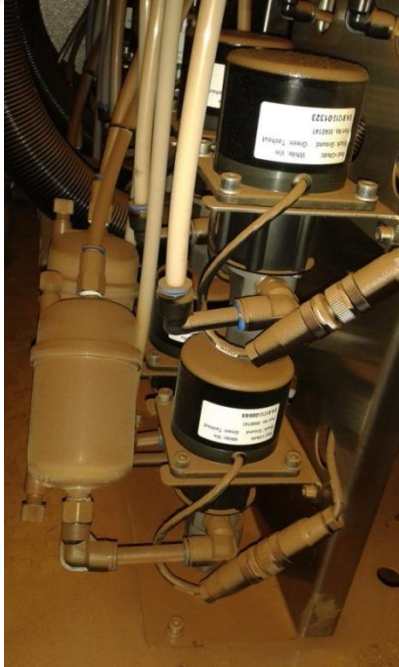
Şekil 33– Aşırı kirlenmiş filtreler - Aşırı kirlenmiş boya hortumları (Fotoğraf: Ahmet Osman Peker)
