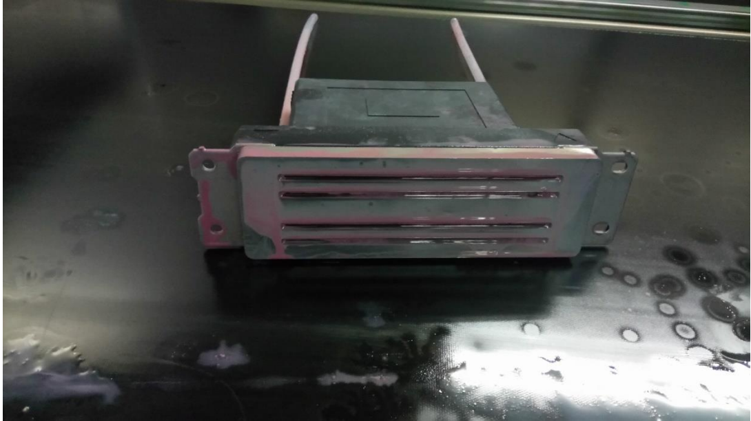
Şekil 42– Tıkanmış püskürtme kafası (Fotoğraf: Ahmet Osman Peker)
