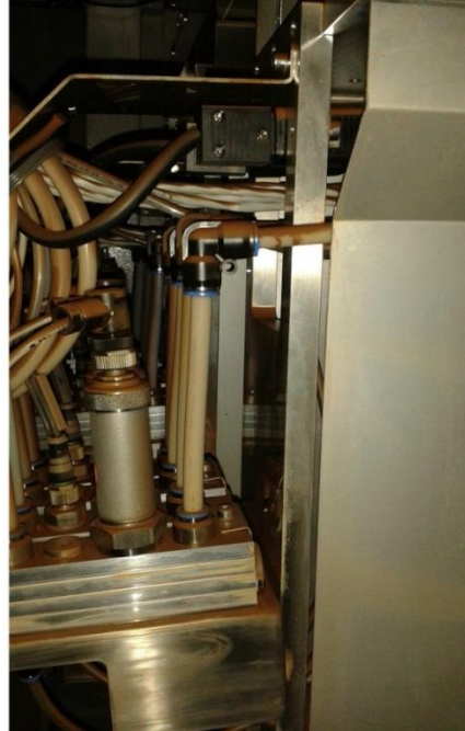
Şekil 33– Aşırı kirlenmiş filtreler - Aşırı kirlenmiş boya hortumları (Fotoğraf: Ahmet Osman Peker)
