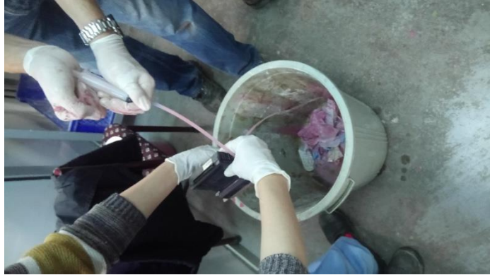
Şekil 43– Püskürtme kafasının solvent ile temizlenmesi (Fotoğraf: Ahmet Osman Peker)
