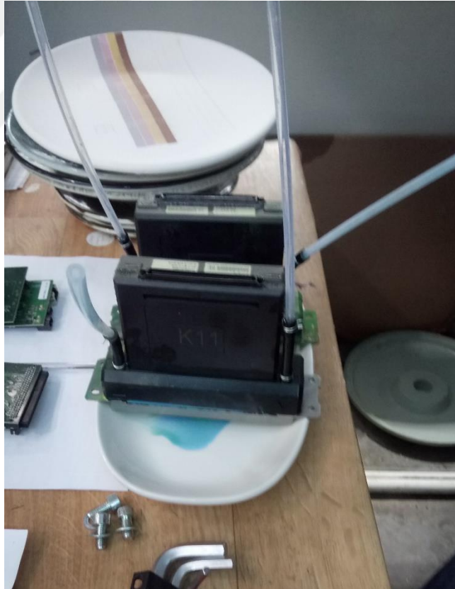
Şekil 44– Temizlenen püskürtme kafası (Fotoğraf: Ahmet Osman Peker)
