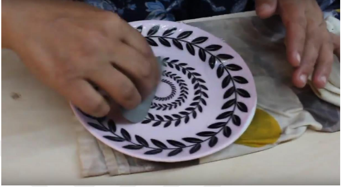
Şekil 3- Çıkartma lastiği ile sabitleme işlemi
