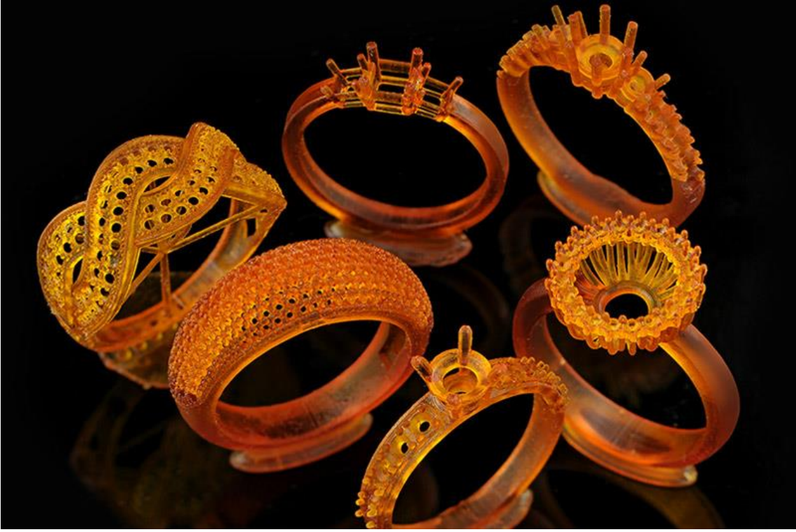
Şekil 5.10: SLA hızlı prototipleme teknolojisi ile modellenmiş takılar
