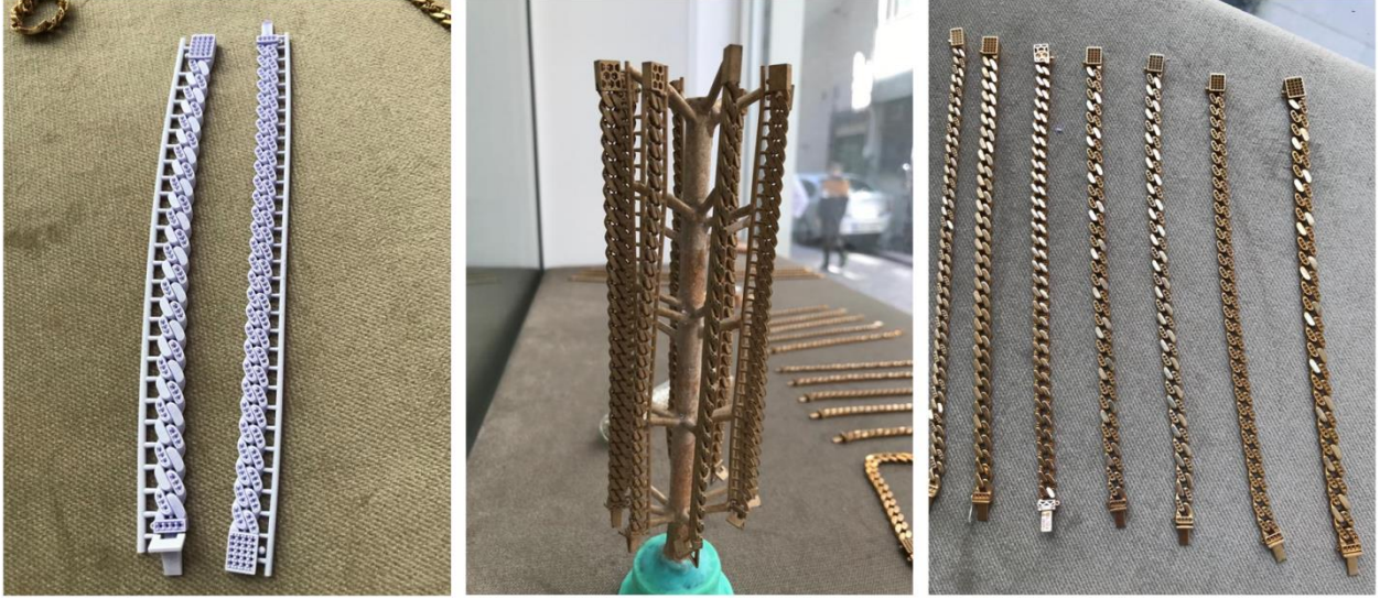
Şekil 5.1: Hızlı prototip üretim yöntemiyle imal edilen zincir modeli
