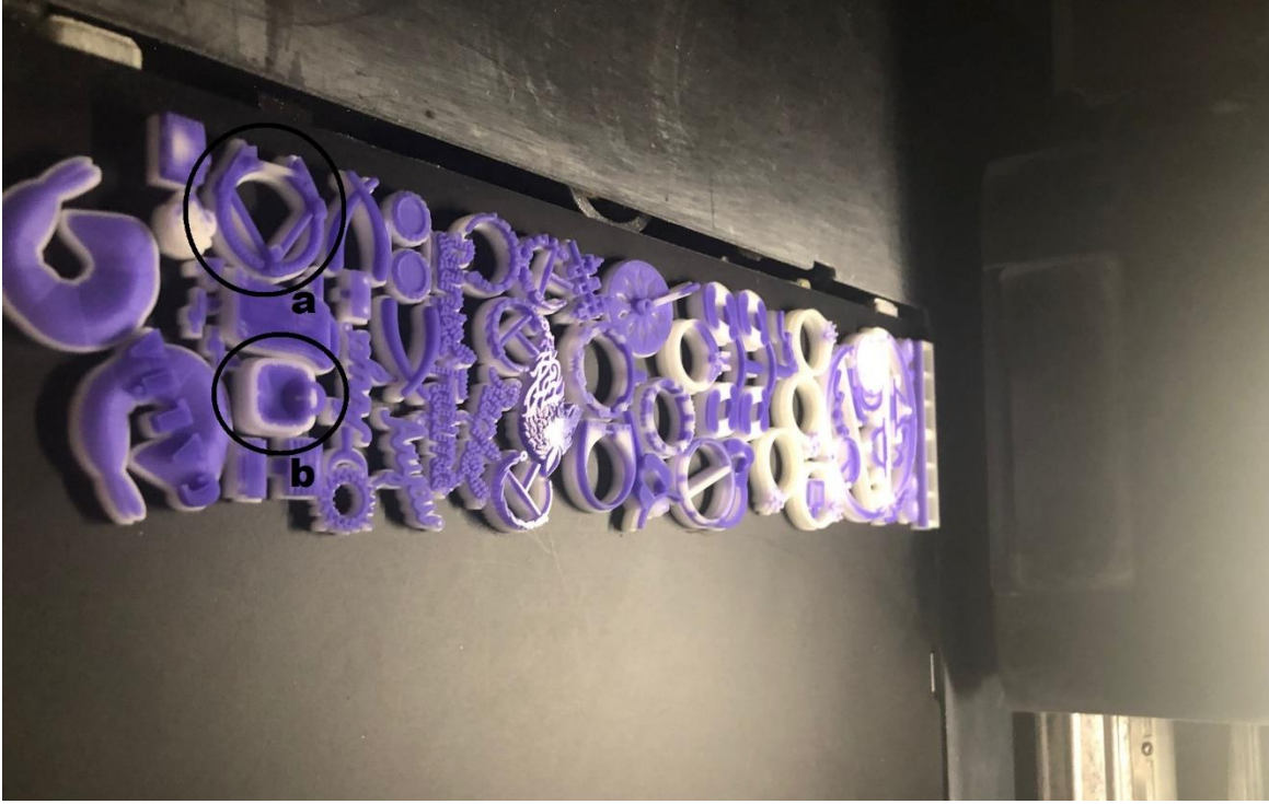
Şekil 5.7: MJM hızlı prototip teknolojisinin inşa aşamasında olan takı prototipleri (a,b)
