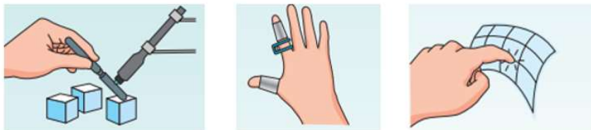
Şekil 9. Sanal dokunuş için Haptik cihaz çeşitleri, Kavranabilir sistem, Giyilebilir sistem ve Dokunulabilir sistem (Baydemir, 2022)
