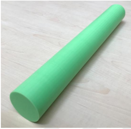
Resim 2.11. Üç-boyutlu yazıcıda basılan boş dairesel silindir (orijinal)
