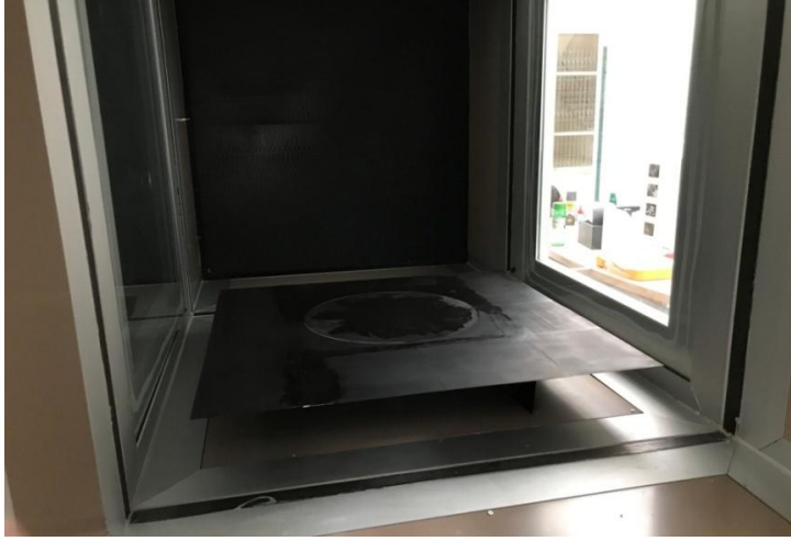
Resim 2.7. Rüzgar tüneli içerisinde bulunan plaka ve döner tabla (orijinal)
