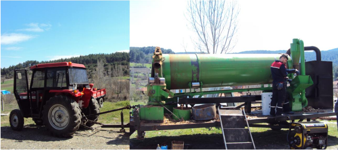
Şekil 4.2. Çalışmamızda kullanılan traktör kuyruk mili tahrikli kombine mobil pelet makinesi.
