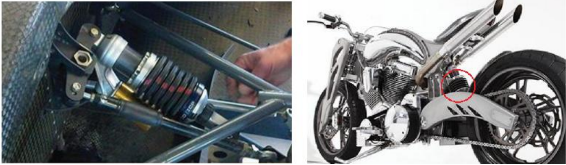
Şekil 3.2. Yarış aracı ve motosiklet süspansiyon sisteminde disk yay kullanımı.
