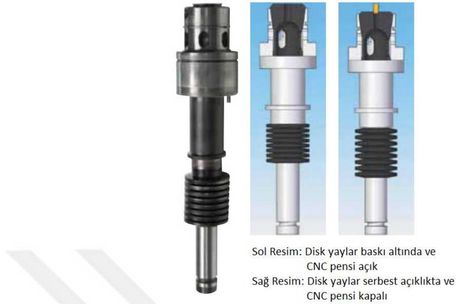
Şekil 3.6. CNC pens sisteminde disk yay kullanımı.
