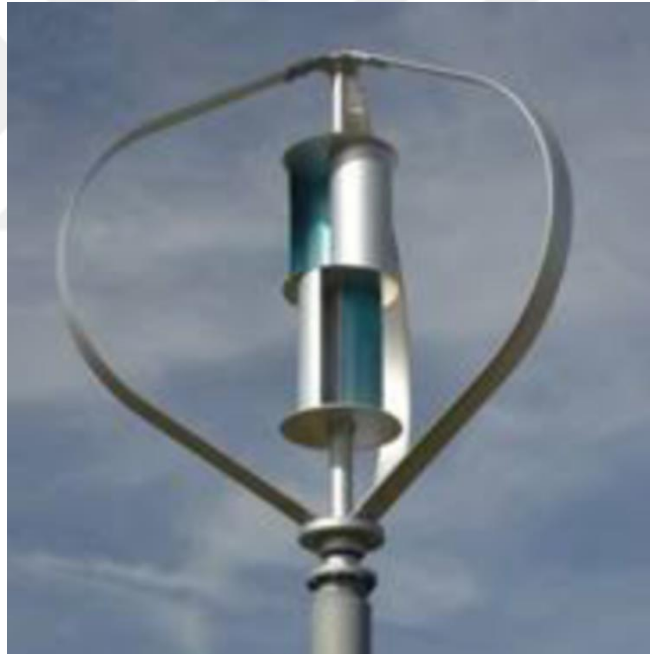
Görsel 2.5. İçi Savonius, dışı Darrieus tipi düşey eksenli rüzgar türbini
