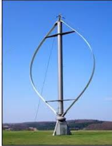
Görsel 2.7. Darrieus tipi rüzgar türbini
