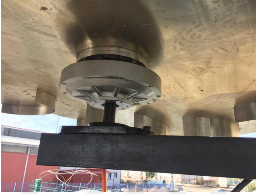
Görsel 4.2. Türbin altından jeneratöre bağlantı
