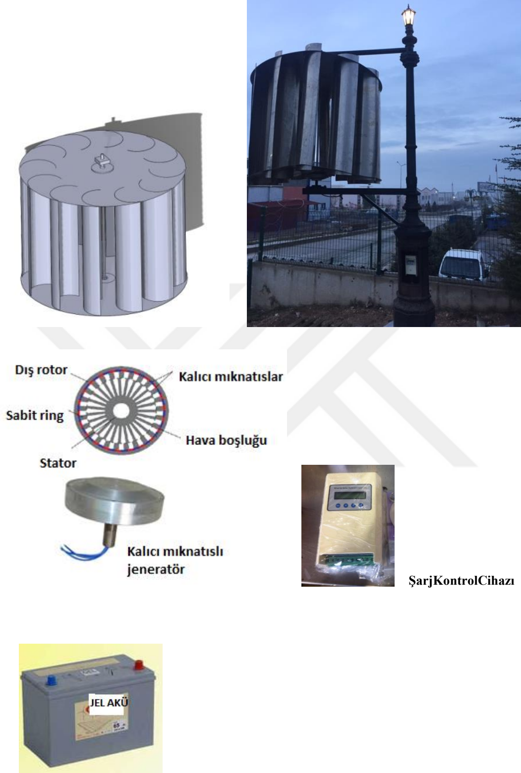
Görsel 4.1. Türbinimizin Parçaları
