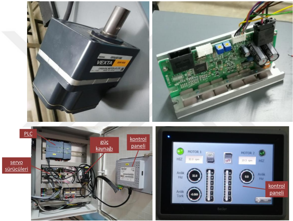
Şekil 4.5. Servo motor, servo motor sürücüsü ve kontrol sistemi
