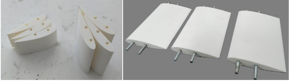
Şekil 4.3. Üç boyutlu yazıcı ile PLA malzemenen imal edilen farklı uzunluktaki NACA 4418 kanatlar
