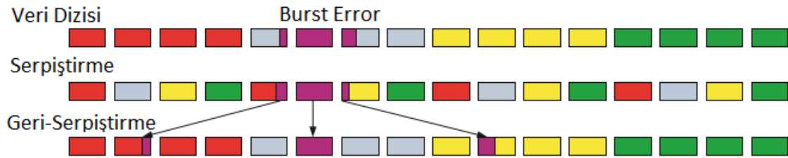
Şekil 4.5. Serpiştirme ve geri-serpiştirme işlemi
