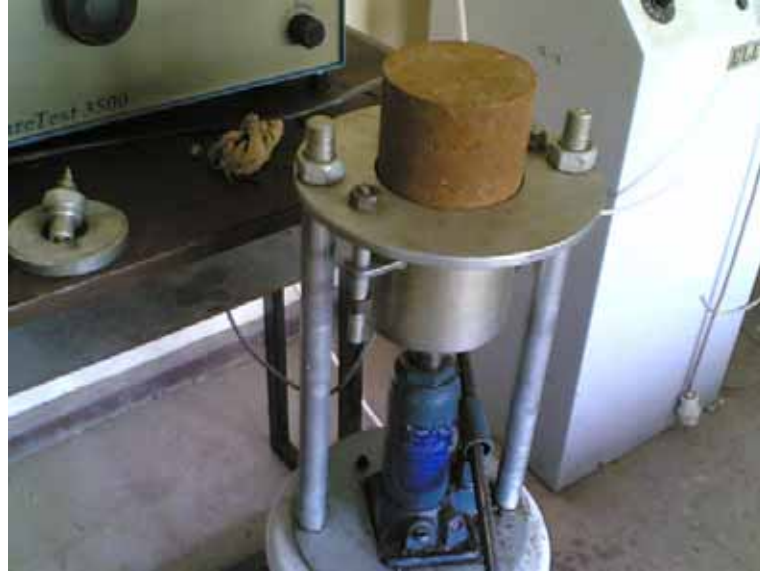
Şekil 3.14. Mold + numunenin kriko yardımı ile çıkartılması
