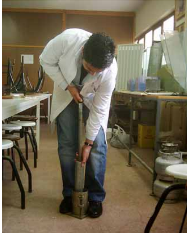
Şekil 3.12. Standart kompaksiyon tokmağı ile 25 darbenin vurulması
