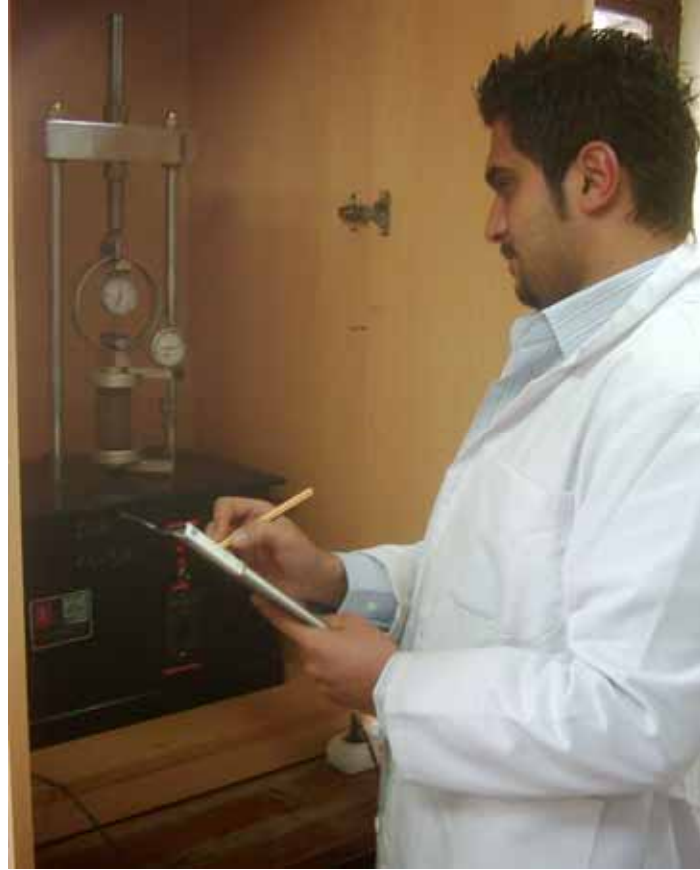
Şekil 3.17. Serbest basınç deney aygıtından okuma alınması
