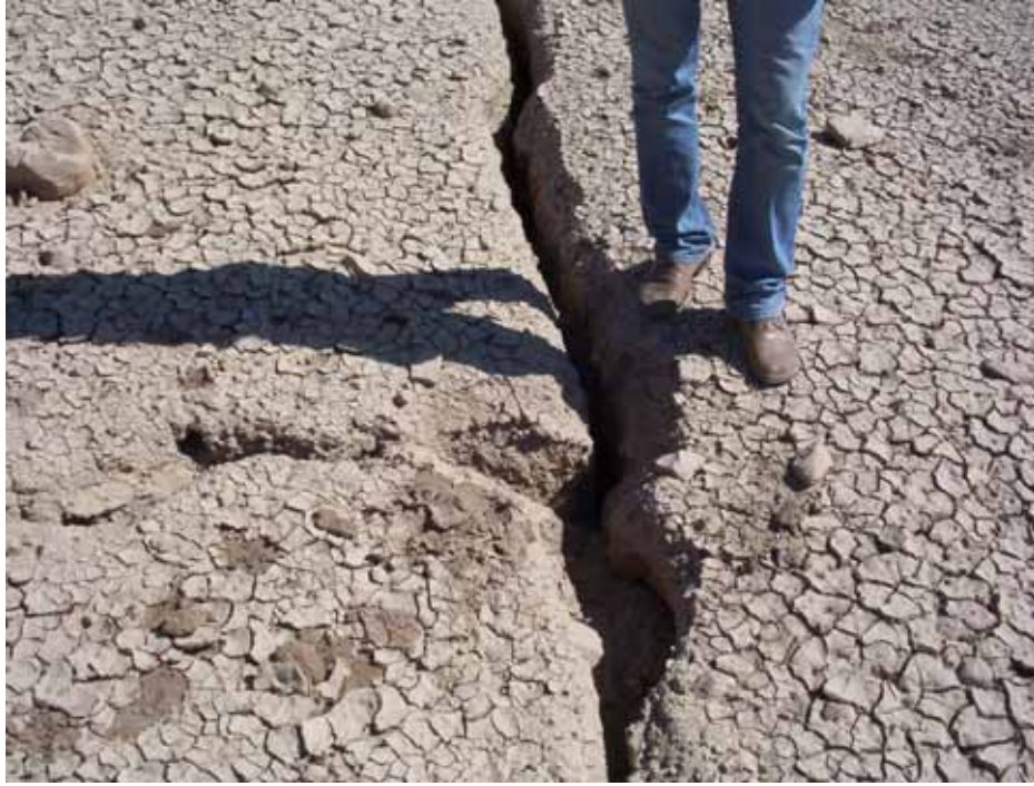
Şekil 4.18. Sol yamaçtaki eklem sisteminin 15-20 cm açıklığı
