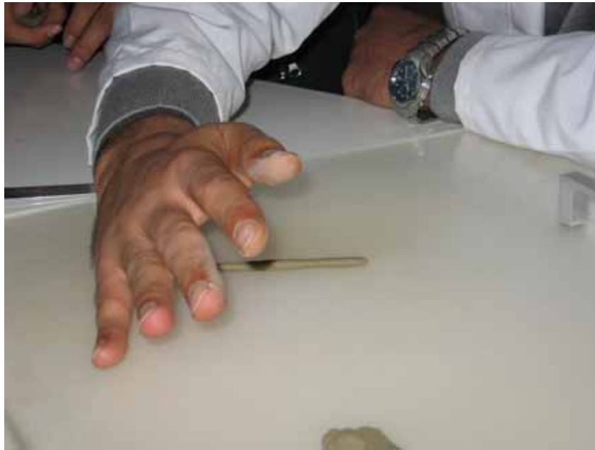
Şekil 3.7. Plastik limitin yapılışı
