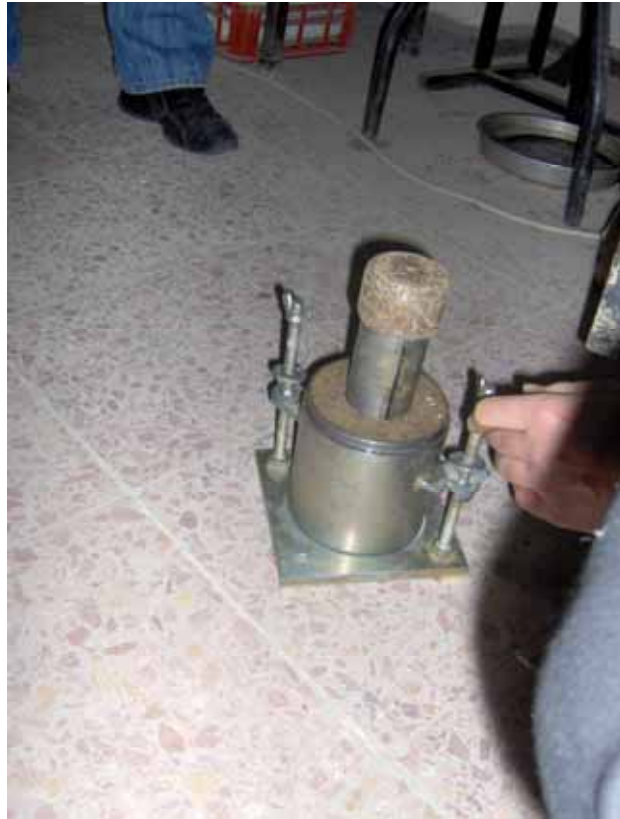
Şekil 3.15. Shelby tüpünün mold içerisine aktarımı
