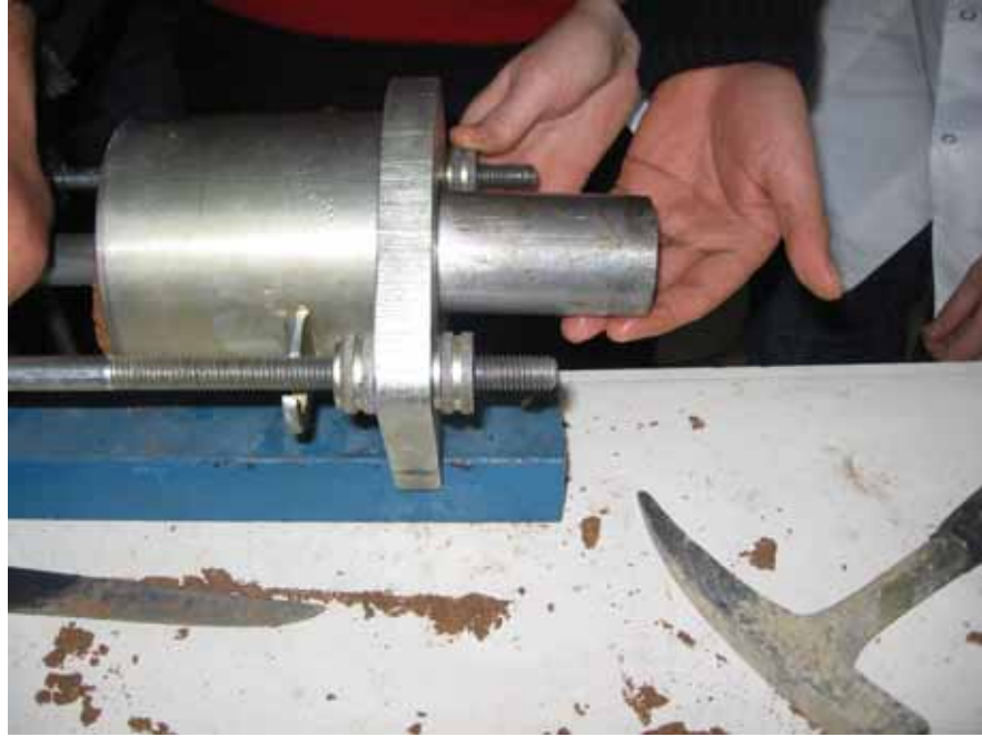
 ekil 3.16. Shelby t p n n kriko yardımyı ile  ıkartılması
