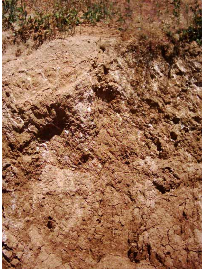
Şekil 4.8. J-AÇ-2 Kılcal sızma izleri
