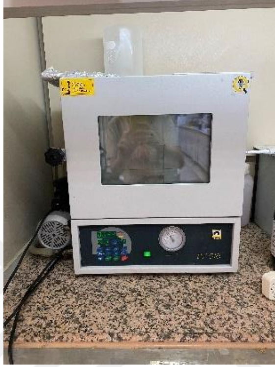
Şekil 4.30. Ara ürün inceleme çalışmalarında vakumlu etüvde numunenin suyunun uçurulma işlemi
