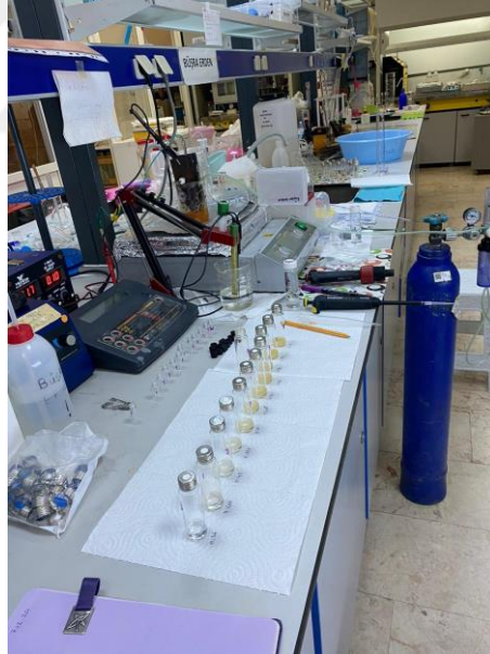
Şekil 3.12. Elektro-Fenton deneyinin laboratuvar ortamındaki düzeneği
