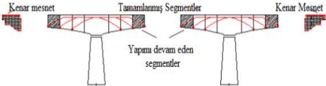
Şekil 1.15. Köprü üstyapısını oluşturan dilimlerin inşasına ait şematik gösterim
