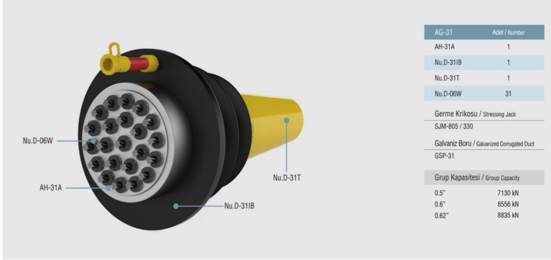
Şekil 1.30. 31'li halat düzenine sahip halat plakası
