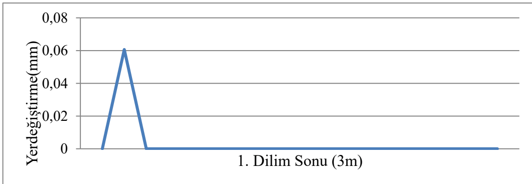
Şekil 3.34. 1. Dilimin yapımı sonucunda elde edilen yerdeğiştirme grafiği
