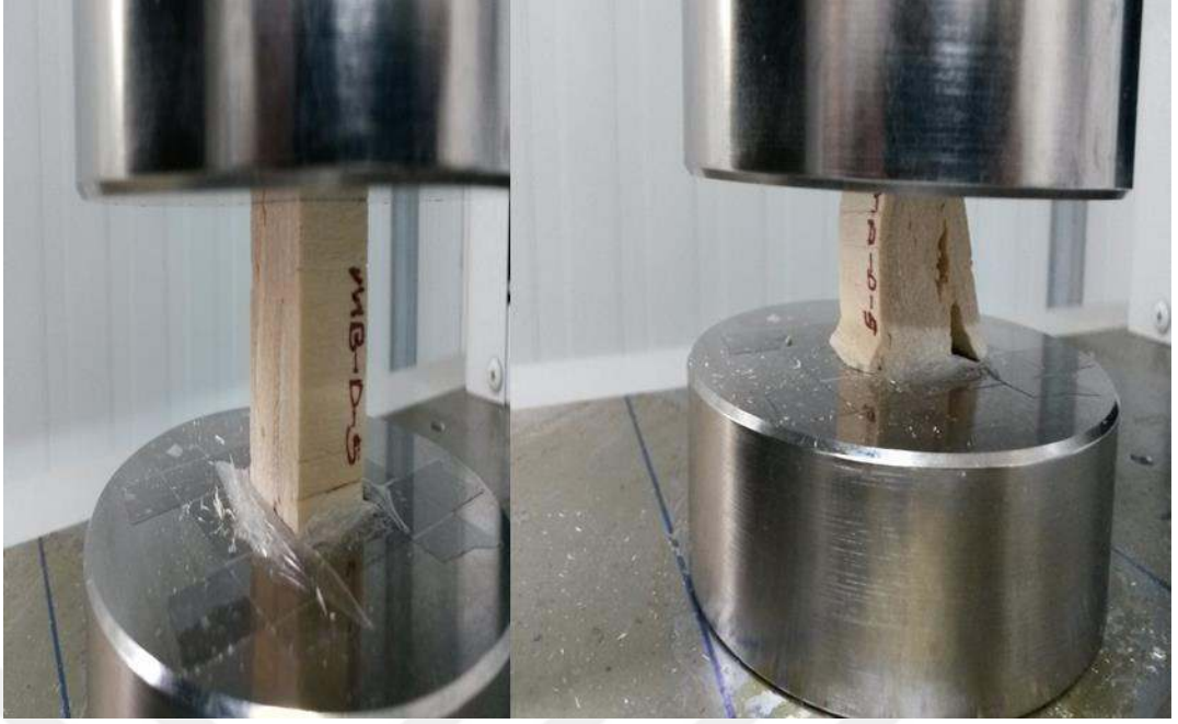
Şekil 2.15 : Liflere dik ve paralel basınç direncinin belirlenmesi.
