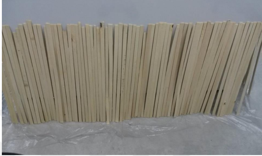
Şekil 2.7 : 24 saat oda sıcaklığında bekletme işlemi.
