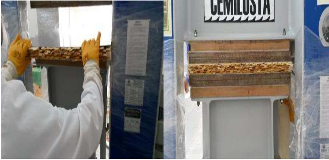
Şekil 2.10 : Taslak haline getirilmiş şeritlerin preslenmesi.
