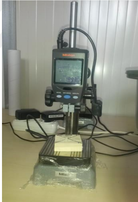
Şekil 2.12 : Dijital kumpas ve ölçüm anı.
