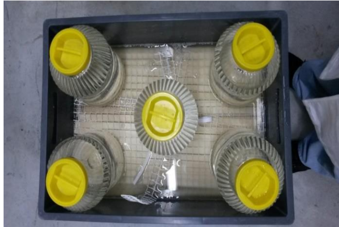
Şekil 2.6 : Şerit kaplamaların daldırma metoduyla modifiye edilmesi.
