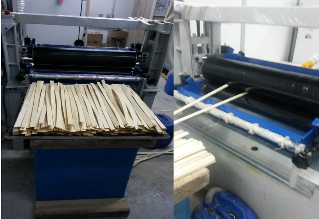
Şekil 2.9 : Şeritlerin tutkallanması ve taslak haline getirilmesi.
