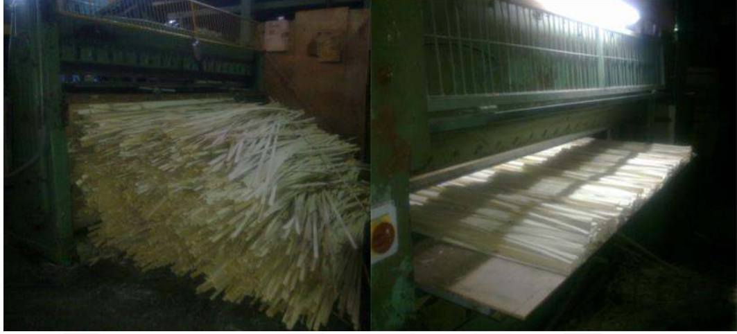
Şekil 2.4 : Kaplama şeritlerinin üretiminde kullanılan giyotin makineleri.
