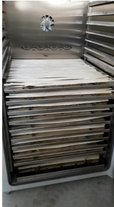
Şekil 2.8 : Etüvde kurutulan kaplama şeritler.
