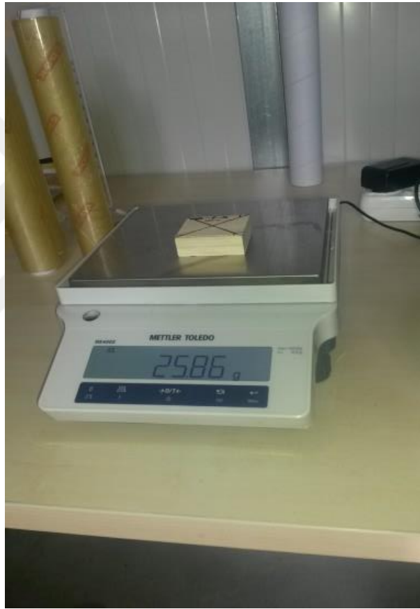
Şekil 2.13 : Su alma miktarının belirlenmesi ve 0,01 hassasiyetteki terazi.
