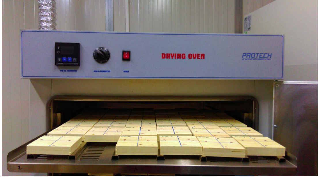
Şekil 2.11 : Numunelerin etüvde değişmez ağırlığa gelmesi.
