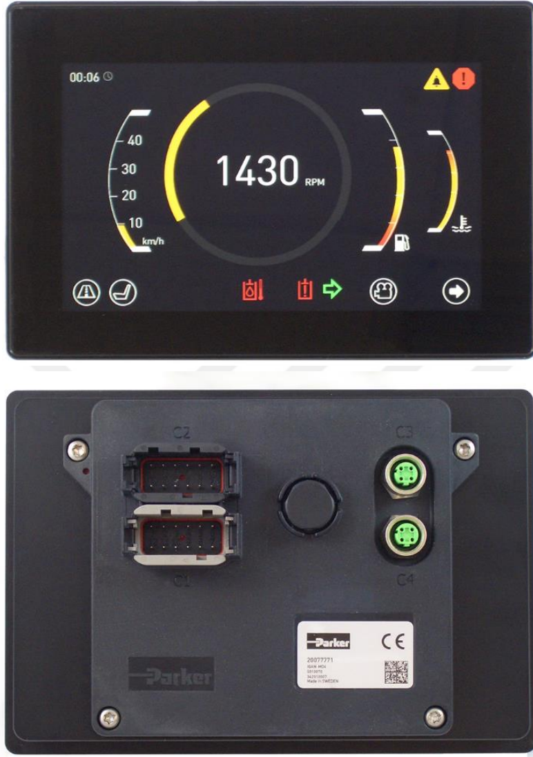
Şekil 3.9: Veri Kaydedici Cihazın Önden ve Arkadan Görünümü
