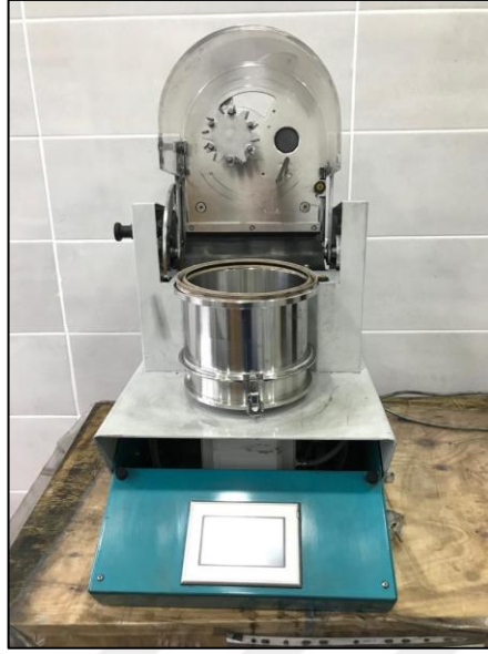
Şekil 4.4. Granül elde etmek için kullanılan laboratuvar tipi karıştırıcı
