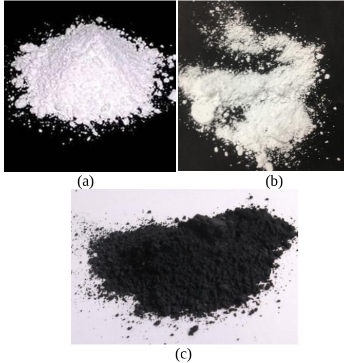
Şekil 4.1. Hammaddelere ait makro görüntüler (a) \text{TiO}_2 tozu, (b) \text{ZrO}_2 tozu, (c) Karbon karası
