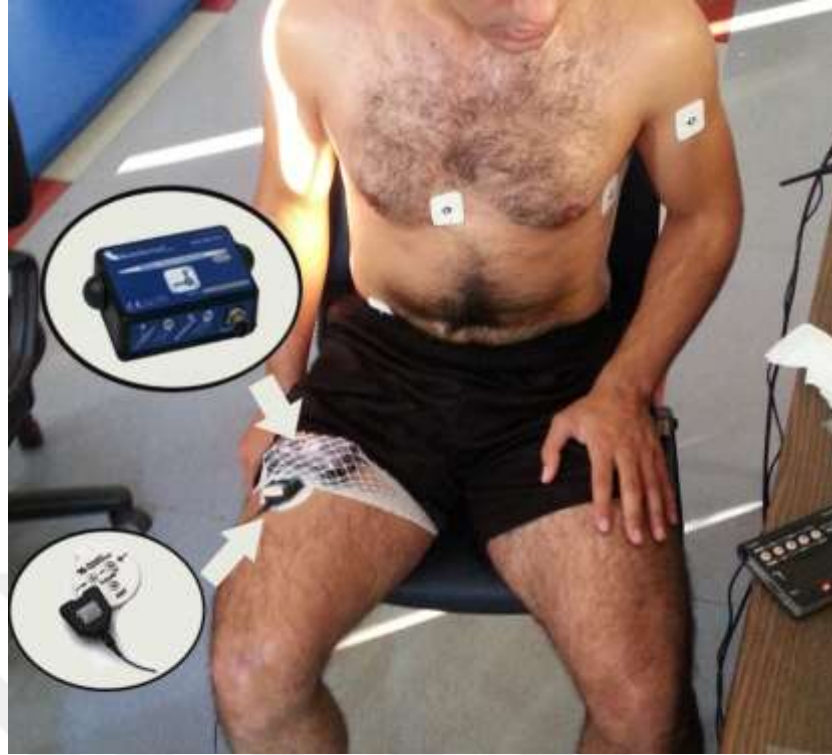
Şekil 3.16. Yüzey elektrot ve ivmeölçerin RF kası üzerine yerleşimi
