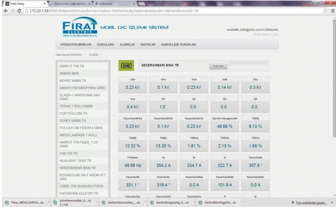
Şekil 6.28. Ölçüm noktası 3, transformatör anlık ayrıntılı ölçüm bilgileri
