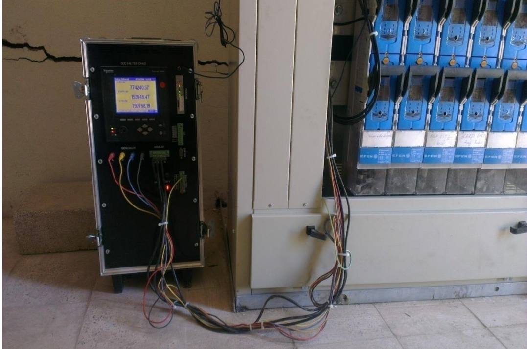
Resim 6.3. Ölçüm noktası 1, değerlerin alındığı GKC ION 7650 güç kalitesi analizörü
