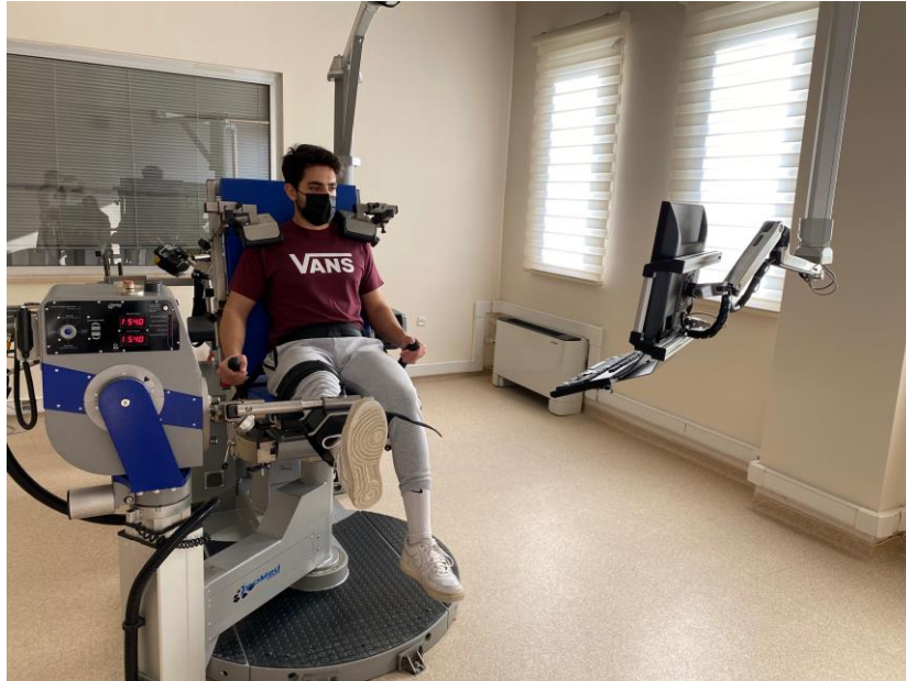
Şekil 3.17. İzokinetik diz kas kuvvet ölçümü
