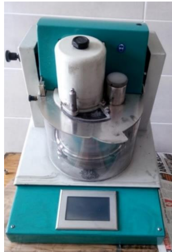
Şekil 5.11. Granül üretmek için kullanılan laboratuvar tipi karıştırıcı.
