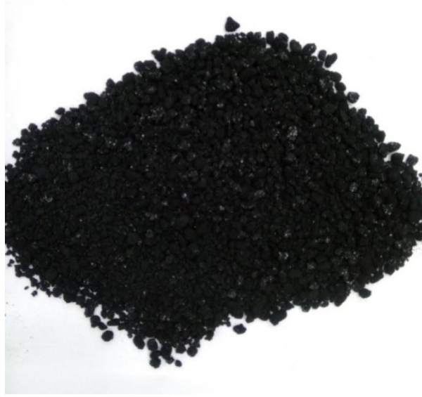
Şekil 5.12. Granülör cihazıyla elde edilen granüller.
