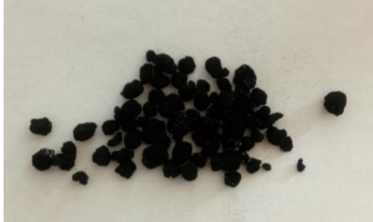
Şekil 5.10. Manuel granülleme ile elde edilen granüllerin makro görüntüsü.
