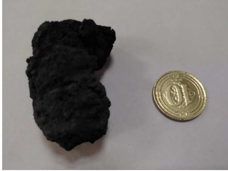
Şekil 6.5. 1C'lu bileşime göre hazırlanan 2000dv/dk hızda 15 dk sürede hazırlanan granüllerin 1400°C'de 1 saat sürede ve binde 5 oranında propan içeren azot-propan gazı altında gerçekleştirilen reaksiyon sonucu elde edilen reaksiyon ürününe ait makro görüntü.
