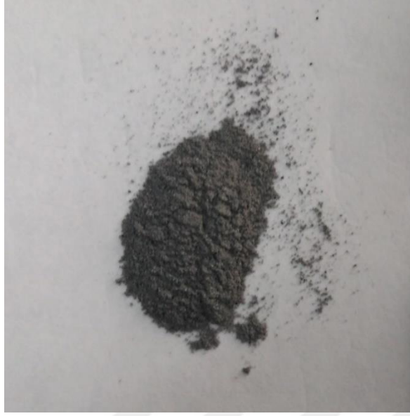
Şekil 5.13. DKTİN işlemi sonrasında öğütülmüş h-BN tozu.
