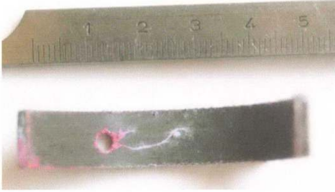
Şekil 149. IV nolu yük altında yatakta oluşan yorulma bölgesi
