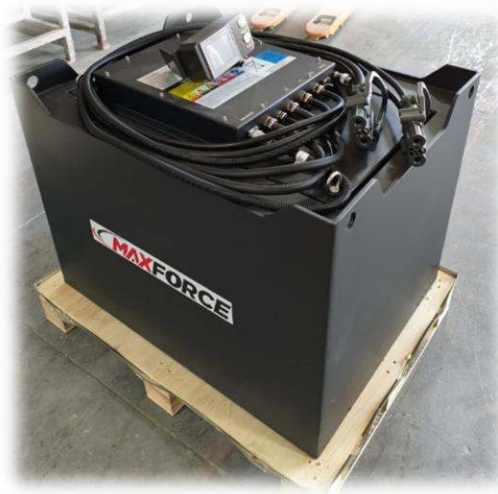
Şekil 3.4 Saha testinde kullanılan 51.2V 554Ah Li-ion batarya
