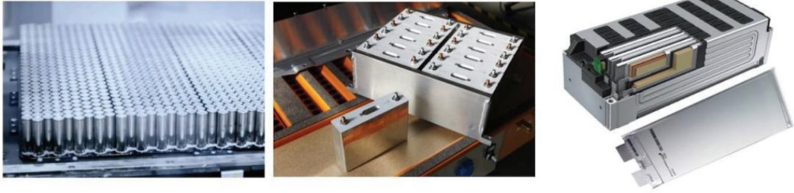
Şekil 2.8 Li-ion bataryaların tipleri sırasıyla silindirik, prizmatik ve kese tipi [43]
