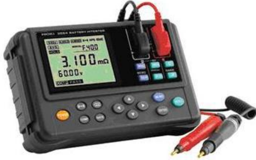
Şekil 2.12 Hioki 3554 iç direnç ölçüm cihazı
