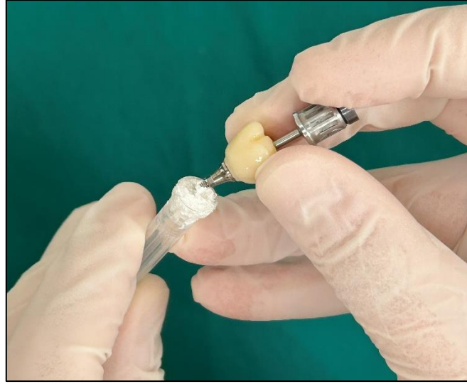
Şekil 2.7. Sol-jel kıvamına getirilmiş tantalyum oksitin dayanak vidasına uygulanması
