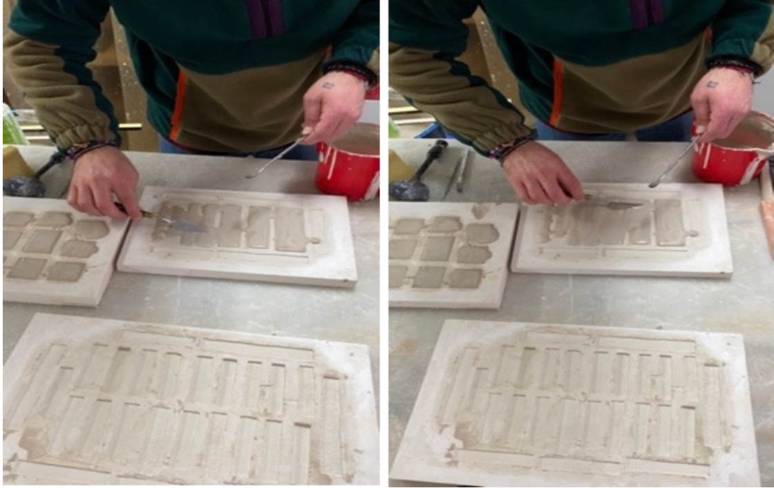
Görsel 3.12. Serkan Tok, Osmanlı Kalyonunun alçı kalıp döküm elle şekillendirme aşaması, döküm porselen çamuru, Serkan Tok fotoğraf arşivi
