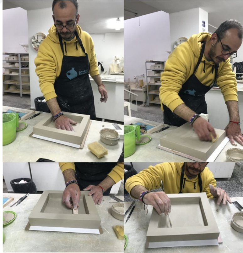
Görsel 3.18. Serkan Tok, Osmanlı minyatür diorama çerçeve yapım aşaması elle şekillendirme, aşaması, Serkan Tok fotoğraf arşivi
