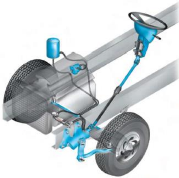
Şekil 1. 1. Araç üzerinde hidrolik güç destekli direksiyon sistemi görünümü (Uymaz, 2019)
