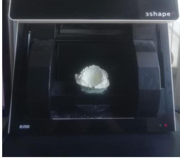
Şekil 15. 3Shape R100 ile hasta modellerinin dijital ortama aktarılması
