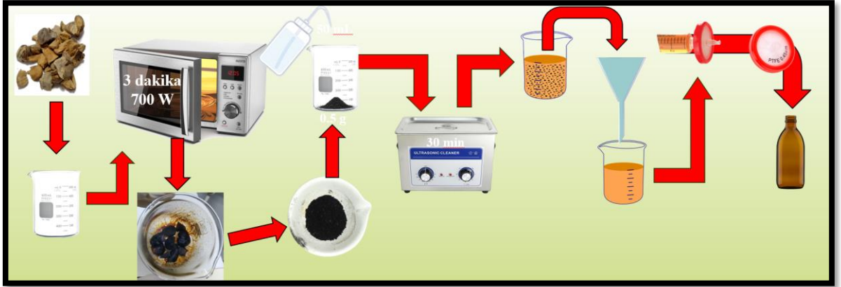
Şekil 11. MPY yöntemi ile gerçekleştirilen KNN sentez şeması
