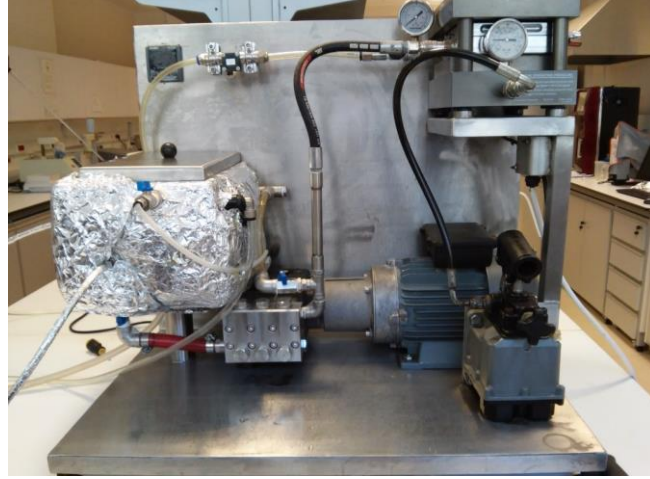
Şekil 3.3. Sürekli işletimli basınç sürücülü membran sistem
