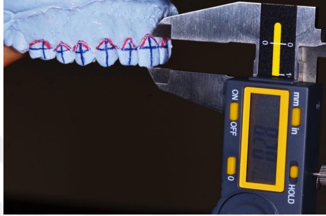
Şekil 5. Dijital kumpas (Asimeto, Hong Kong) ile KU ölçümü
