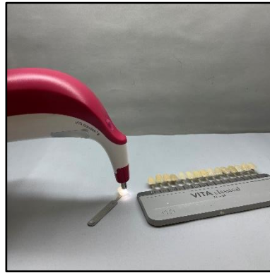
Resim 33. VITA Classical A1-D4 renk skalasındaki renklerin spektrofotometre ile ölçülmesi
