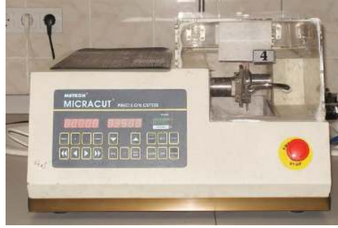
Şekil 3.9. Örneklerden kesit alınmasını sağlayan hassas kesme cihazı
