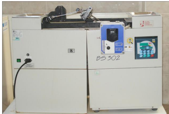
Şekil 3.8. Çalışmada kullanılan termal siklus cihazı
