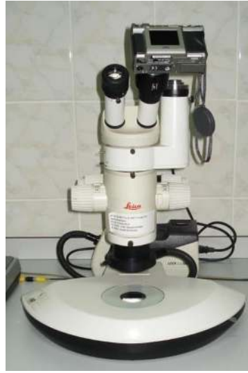
Şekil 3.10. Örneklerde oluşan mikrosızıntı değerlendirmesi için kullanılan ışık mikroskobu
