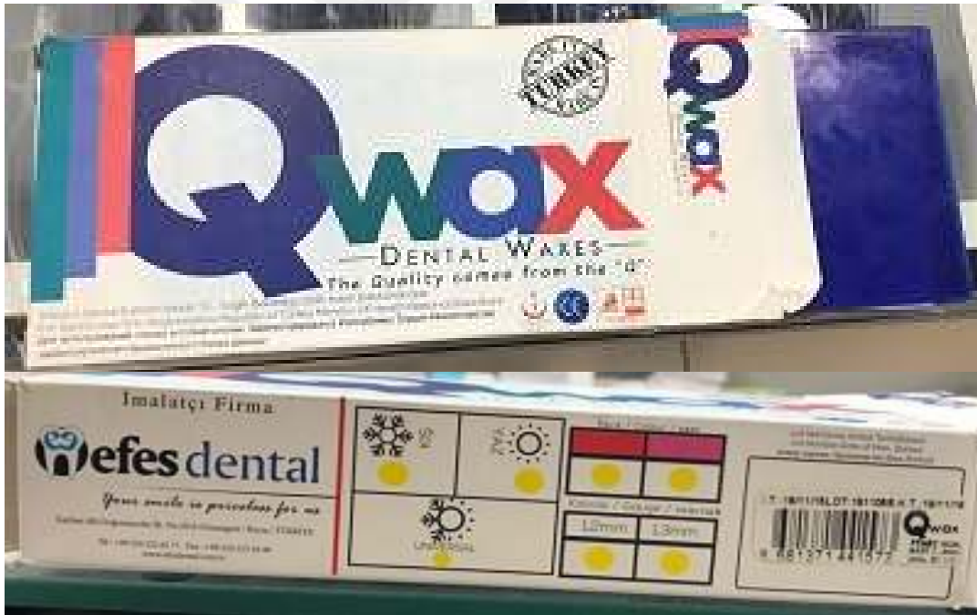
Resim 23. Çalışmada kök kırıkları arasındaki mesafeyi ayarlamak için kullanılan 0,2 mm kalınlığındaki döküm mumu (Qwax, Efes Dental, Türkiye)
