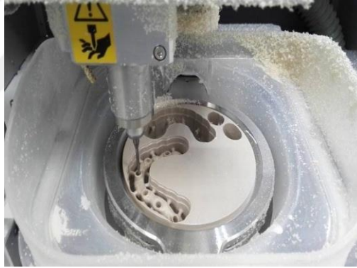
Şekil 3: CAD/CAM ile PEEK Üretimi
