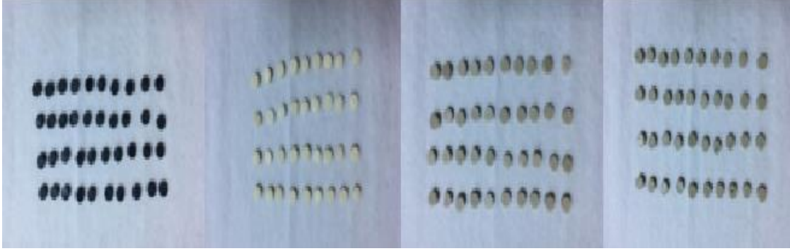
Şekil 18: Disk Şeklinde Kesilmiş PEEK Örnekler (CFR-PEEK, seramik ilaveli PEEK, GFR-PEEK, Doldurucusuz PEEK)
