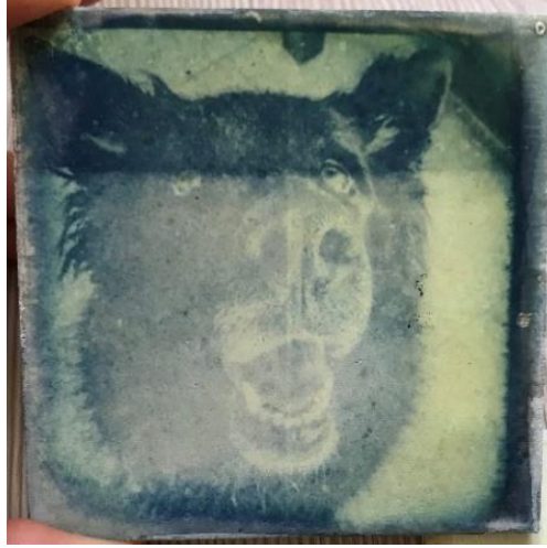
Görsel 4.48. Eşit düzeyde kurumayan jelatinin baskı sonucuna etkisi (Araştırmacı Arşivi)
