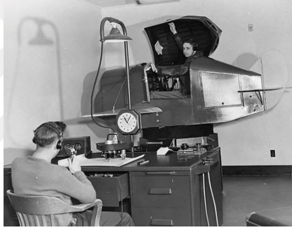
Görsel 2.22. Edward Link'intasarladığı link trainer simülatörü ( http-20 ).
