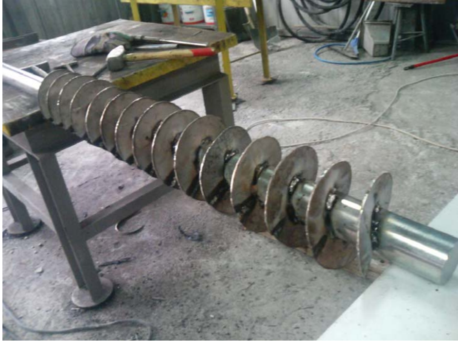
Resim 5.4. Helezon konveyör mili ve yaprakları
