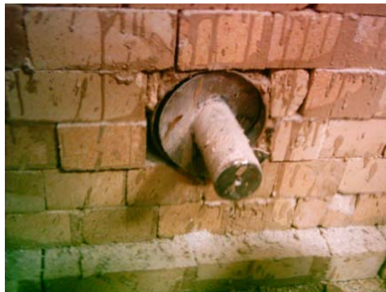
Resim 5.7. Helezon konveyörün fırına giren uç kısmı
