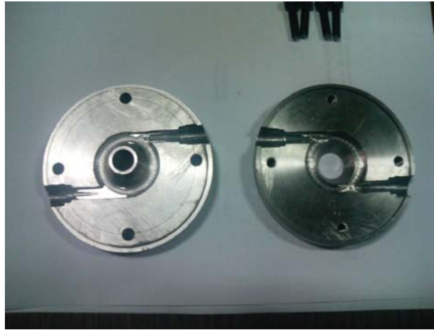
Resim 5.11. Mannesman tipi nozulun üst ve alt kısımlarının görünümü
