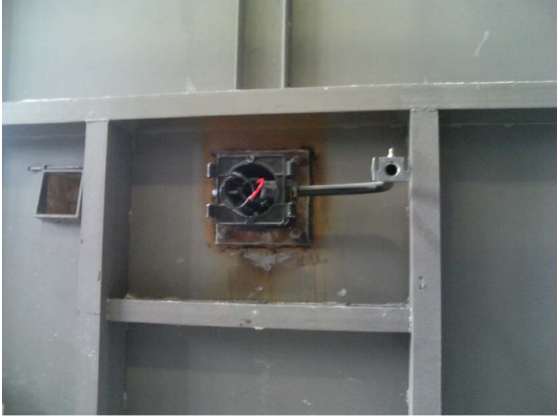
Resim 5.1. Brülör yerleştirilen kısım ve gözetleme deliği
