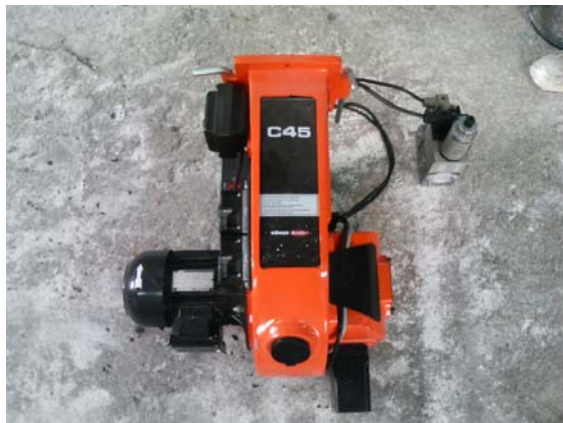
Resim 3.1. Fırın için seçilen doğalgaz brülörü
