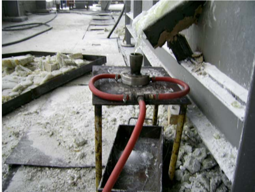
Resim 5.12. Mannesman tipi nozulun denenmesi
