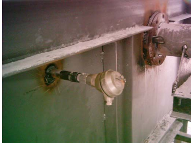
Resim 5.14. Fırın yan yüzeyine yerleştirilen NiCr-Ni termokupl
