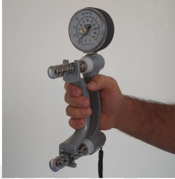
Şekil 36: El Dinamometresi, Grip Skoru Ölçüm Cihazı. Bir hidrolik ölçüm cihazıdır ve statik kavrama kuvvetini kilogram veya pound cinsinden ölçmek için kullanılır (Jamar Hydraulic Hand Dynamometer, Performance Health, Warrenville, USA).
