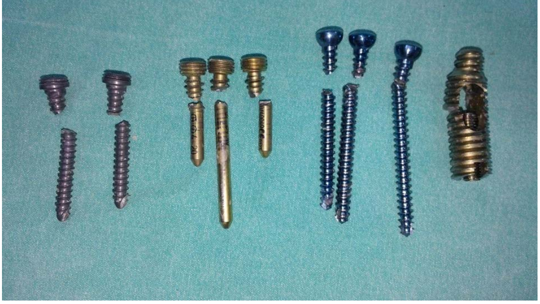
Şekil 3.8c: Kırılmış vida görüntüleri sırası ile ZIMED, ORTHOFIX, TIPMED, TST
