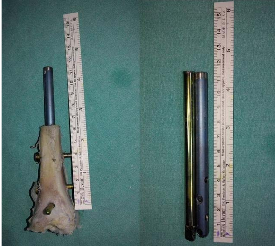
Şekil 3.6: Çivilerin distali 11 cm kalacak şekilde kesilmiş hali
