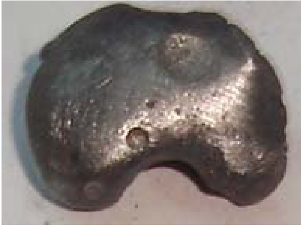
c) 3 no.lu numuneden üretilen demir tanesinin görünümü.
