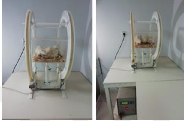
Şekil 3.4. Manyetik alan sistemi ve güç kaynağı
